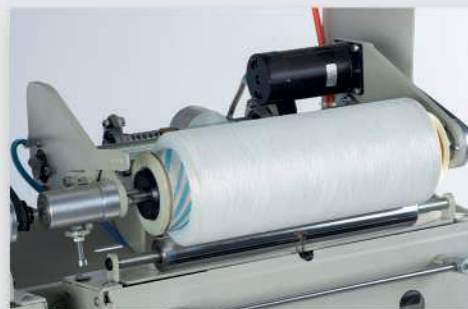
مکانیزم دسته تنظیم تراکم مکانیکی و سنسور سایز دوک Bobin density seting unit and size sensor
