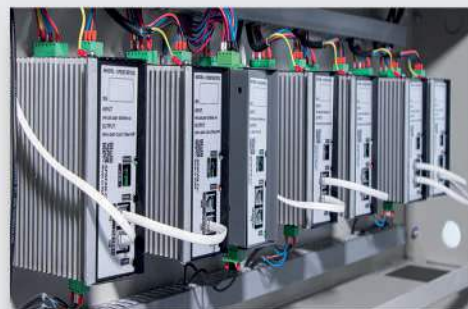
دربارو اختصاصی به ازای هر پوزیشن با قابلیت اتصال به اینترنت special motor driver for each motor
