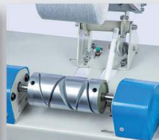
سنسور پروکسی (سایز دوک) Bobin size sensor
