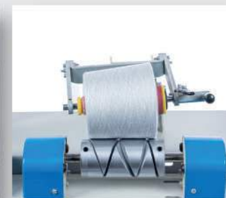
مکانیزم دسته وایتدر Bobin holder winding unit
