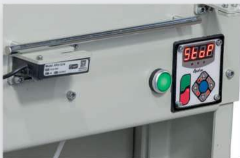
پنل کنترل و سنسور قطع کن به ازای هر پوزیشن Digital speed control unit
