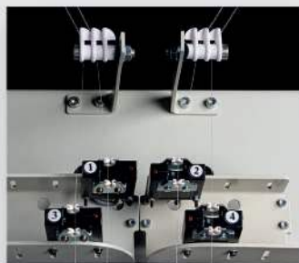
سنسورهای حساس برای لاکتی High sensitive doubling sensor
