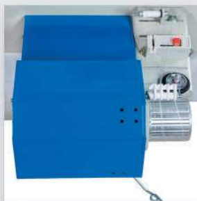
مکانیزم فیدر Yarn tension and feeding unit
