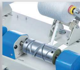
تنظیم تراکم دوک Bobin density setting unit
