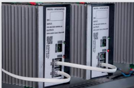
درايو اختصاصی به ازای هر پوزیشن با قابلیت اتصال به اینترنت special motor driver for each motor
