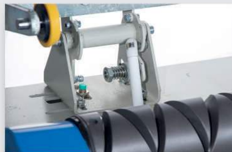
مکانیزم دسته تنظیم تراکم مکانیکی و سنسور سایز دوک Bobbin density setting unit and size sensor
